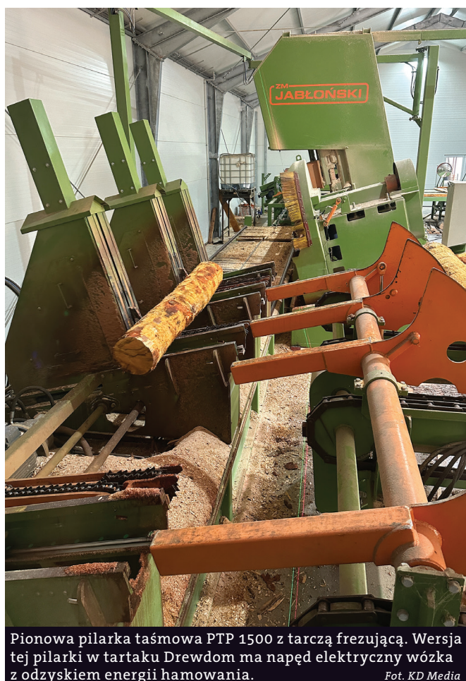
Dzięki zastosowanym rozwiązaniom – w procesie przetarcia nie występują rzżyny i opoły, a zrębki o wartości handlowej.
