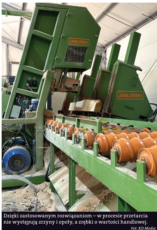
Pionowa pilarka taśmowa PTP 1500 z tarczą frezującą. Wersja tej pilarki w tartaku Drewnom ma napęd elektryczny wózka z odzyskiem energii hamowania.
